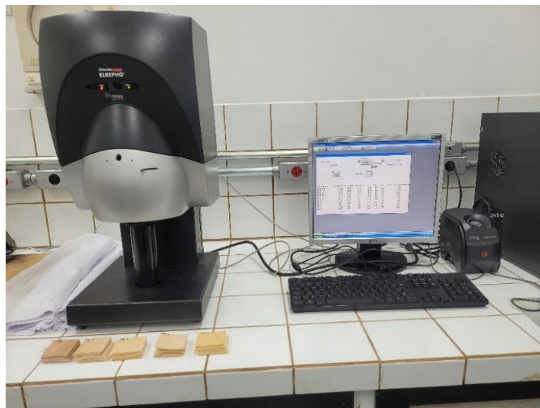
Figura 3. Realização dos ensaios ópticos no espectrofotômetro
