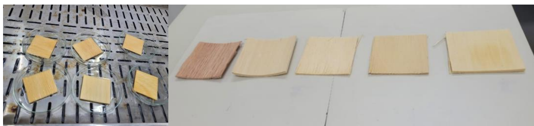
Figura 1. Modificação química das lâminas de Eucalyptus grandis , onde, à esquerda branqueamento e, à direita, lâminas após o tratamento
