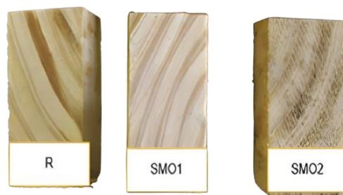
Durante o procedimento, tanto a amostra quanto os tempos de queima foram controlados com o auxílio de um cronômetro. Para cada amostra foram anotados os dados referentes ao tempo de ignição e chama. O tempo de ignição é o tempo mínimo de exposição necessário para o início da queima de modo espontâneo. O tempo de chama mede o tempo que a amostra requer para extinguir a chama após a exposição contínua.
